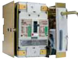
В выдвижной модели выключатели **Record Plus™** для монтажных рам FE и FG используют стандартное втычное основание, которое установлено на металлическую опорную подушку. На металлической подушке предусмотрена накладная пластина, которая выступает через дверцу или панель.
